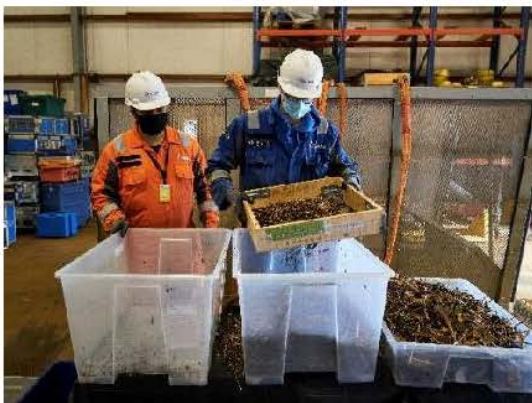
Figuur 6-3: Stap 2 van het behandeling proces – De mix wordt twee keer gezeefd.
