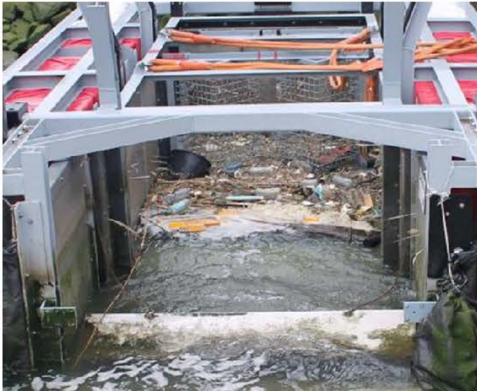
Figuur 5-8: Tracers in de plasticvanger op 06 augustus, vier uur na het begin van de testen. Het water staat terug hoger.
