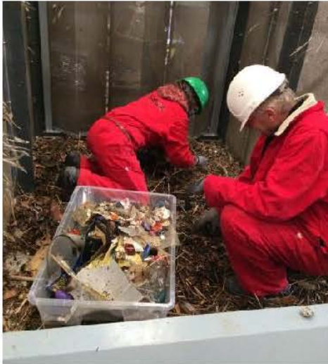
Figuur 6-1: Stap 2 van het behandeling proces – Handmatig sortering van het afval in de opvangbak.
