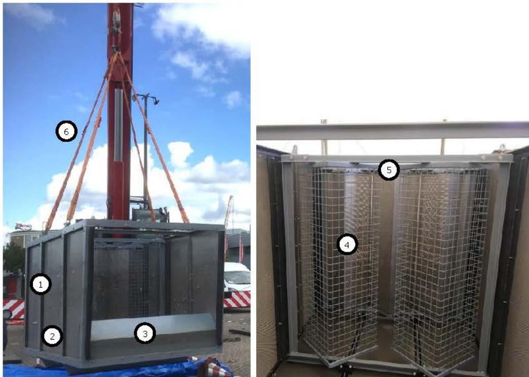
Figuur 3-11: Opvangbak met: (1) staalstructuur, (2) wanden en bodem uit geperforeerd plaatmateriaal, (3) een drempel die voorkomt dat het vuil uit het systeem ontsnapt tijdens het hijsen voor lediging, (4) en (5) schotten die voorkomen dat het vuil uit het systeem gaat als het water uit het systeem uitstroomt, (6) een viersprong voor lediging.
