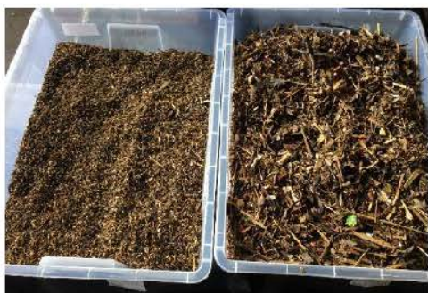
Figuur 6-4: Stap 2 van het behandeling proces – Mix afval na zeven – Links < 5 mm, rechts 5-25 mm
