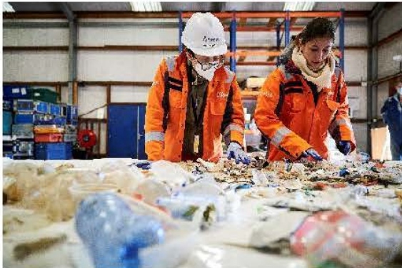
Figuur 6-7: Stap 3 van het behandeling proces – De OSPAR-rivier analyse en de analyse voor verwerking worden uitgevoerd.
