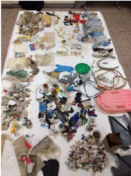
Figuur 6-8: Sortering van het afval volgens de OSPAR-rivier methodiek. Hier is het gedeelte plastic van het afval te zien.
