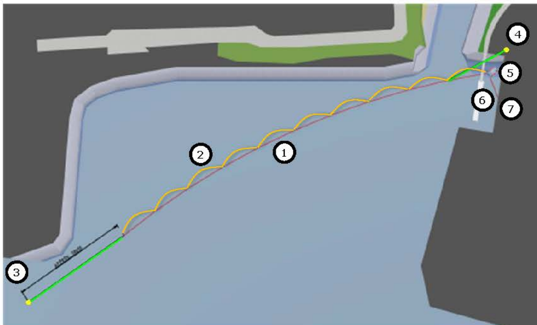
Figuur 3-2: De 200 m afleider (1) bestaat uit 10 secties van 20 m die aan elkaar en aan een Dyneema lijn verbonden zijn (2). Hij is afgemeerd aan een paal van DFDS Seaways (3), aan een bolder van RWS bij de kade van Mammoet (4) en aan één van de spudpalen waar het vangstelsel is afgemeerd (5). De 12 m afleider (6) is gemaakt uit een unieke sectie. Hij is afgemeerd aan de vangarm (4) en aan de kademuur van Mammoet (7).
