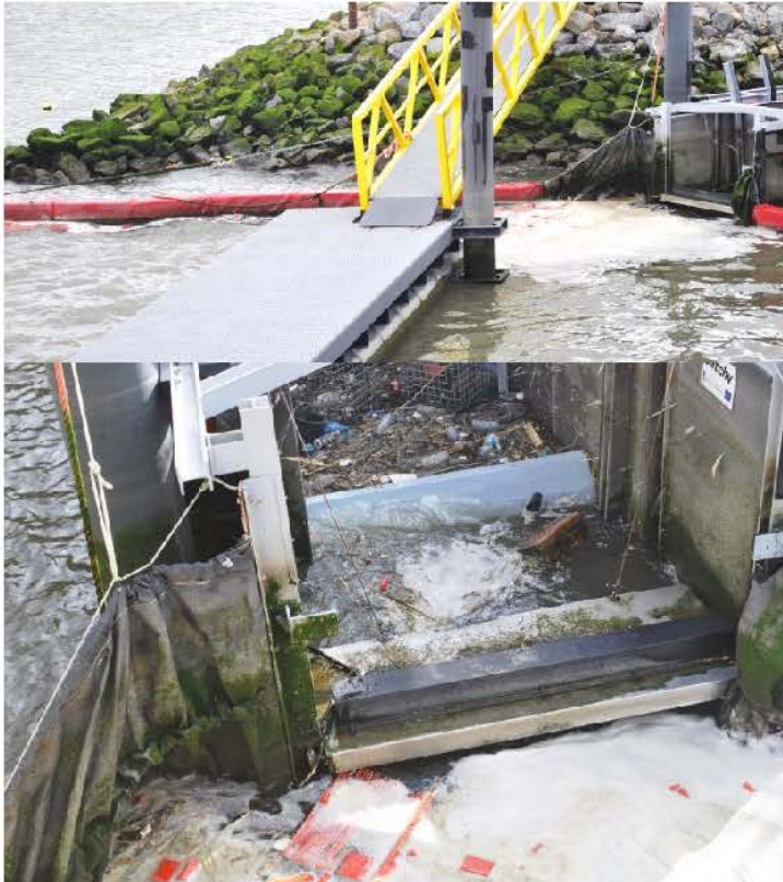
Figuur 5-6: De tracers worden naar het systeem geleidt, maar kunnen nog niet de kool in wegens eb. Het waterniveau staat nog net onder de grijze drempel.
