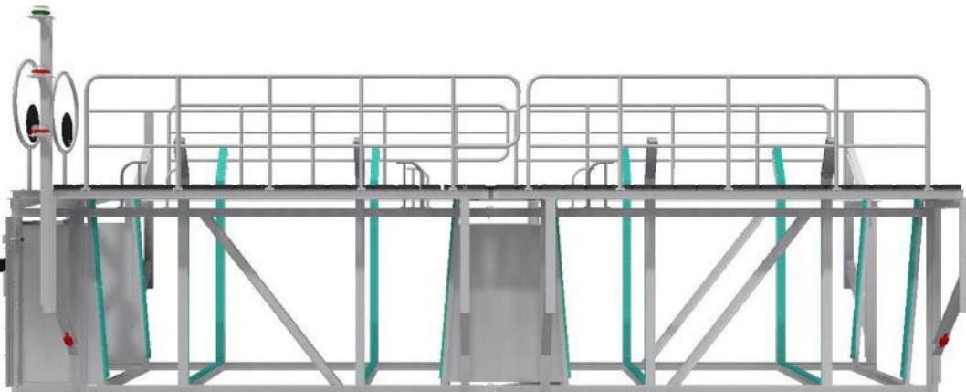
Figuur 10-4: Anodes op het drijvend frame - Dokzijde.
