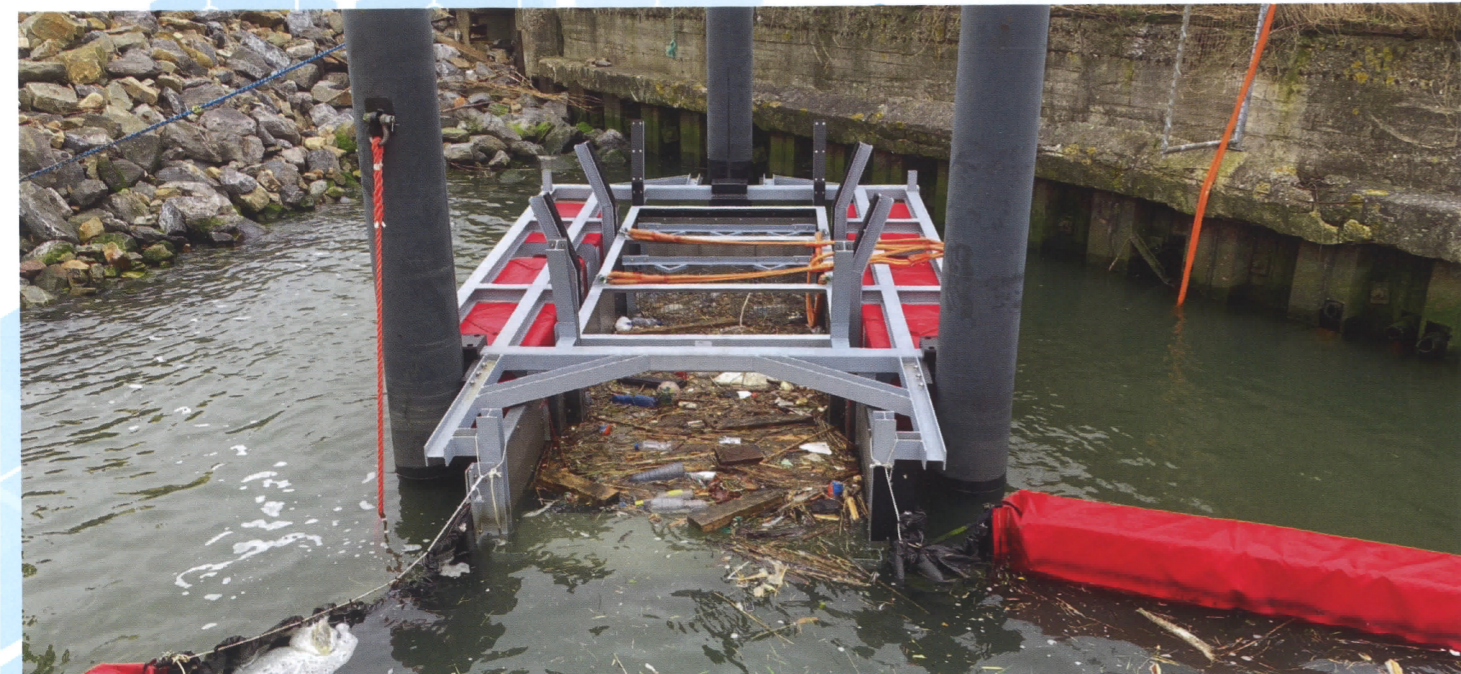
Het systeem heeft tijdens de pilot zowel zwerfafval aan de oppervlakte als 1 meter onder water opgevangen. Gevonden werden zowel macro-plastics (> 5 mm) als grote micro-plastics (> 3 mm).
