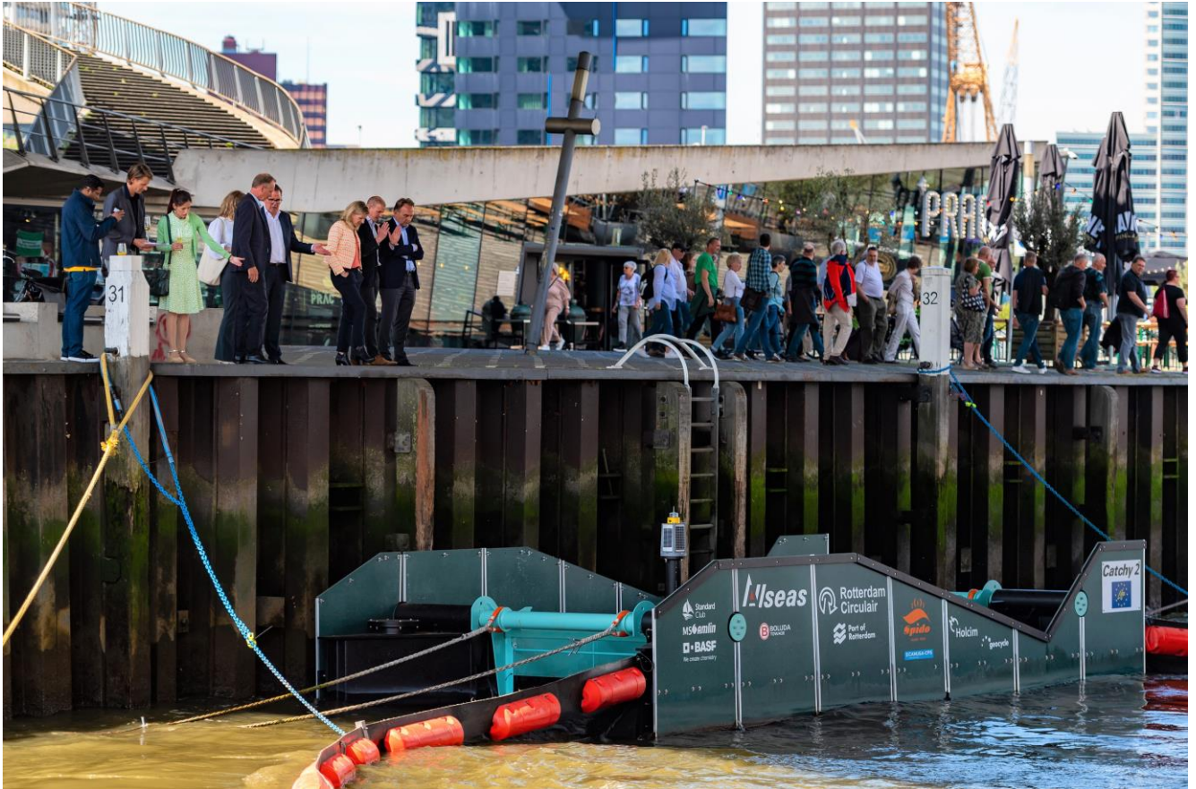
Alseas' opvangsysteem voor zwerfafval, Catchy 2, in werking onder de Rotterdamse Erasmusbrug in de Nieuwe Maas Alseas waste collection system, Catchy 2, in operation under Rotterdam's Erasmus Bridge in the Nieuwe Maas
